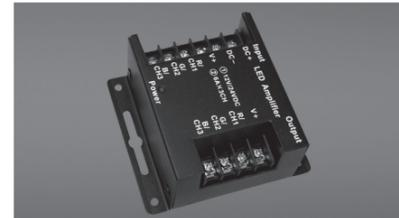
**SOMMAIRE :** L'amplificateur RVB reçoit le signal de modulation de largeur d'impulsion (PWM) du contrôleur vous permettant d'installer des longueurs multiples à partir d'un seul contrôleur. Elles sont alimentées individuellement par un bloc d'alimentation de classe 2. Le bloc d'alimentation de courant devrait correspondre au wattage de la longueur de ruban LED que vous contrôlez.
